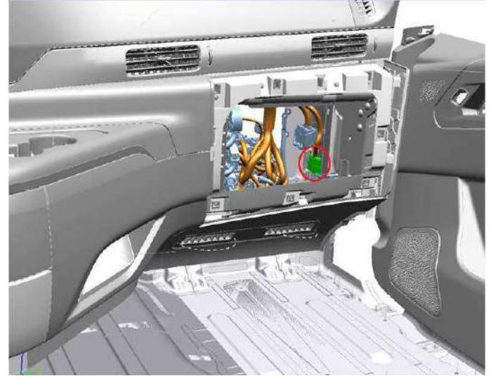
Kabin içinde-torpedo gözünde bulunan üstyapı konnektörünün araç üzerindeki lokasyonudur
