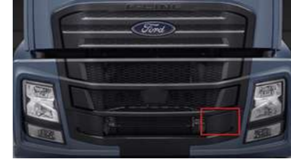
Radar ön ızgaranın arkasındadır.
