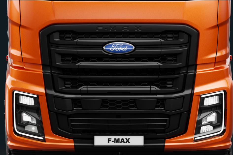
» Die aktiv gesteuerten Klappen vom Frontgrill sind Teil eines ausgeklügelten Systems. Dadurch wird die aerodynamische Effizienz des Lkw gesteigert und das essenziell Situations- und bedarfsgerecht öffnen oder schliessen die LIN-BUS gesteuerten Aktuatoren den Frontgrill und regeln so den Luftstrom zum Motorraum.
