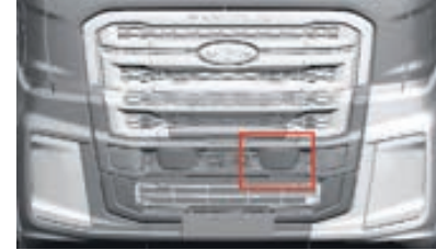
Kamera ön camın arkasına yerleştirilmiştir.
