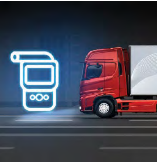
ÉTHYLOTEST ANTIDÉMARRAGE Le moteur démarre uniquement si le conducteur réussit l'alcootest, évitant ainsi la conduite sous l'emprise de l'alcool.
