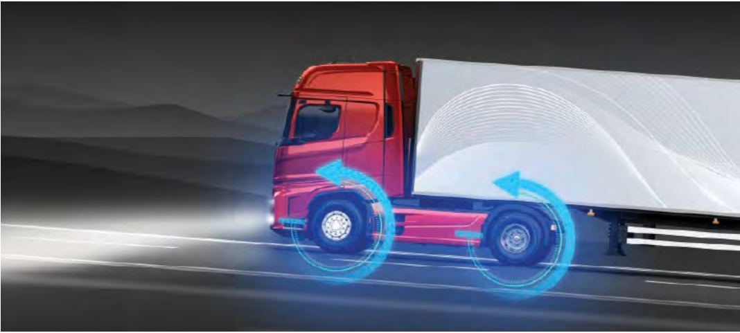
AIDE AU DÉMARRAGE EN CÔTE Empêche le véhicule de dériver lors du démarrage et vous aide à le maîtriser lors du freinage ou de la conduite sur route glissante.
