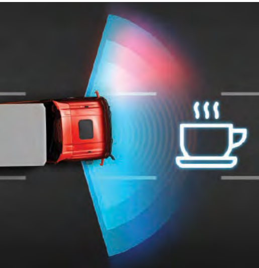
DDAWS - SYSTÈME D'ALERTE DU CONDUCTEUR Le système utilise une caméra pour détecter d'éventuels signes de somnolence ou de distraction du conducteur. Le cas échéant, il en informe le conducteur par un avertissement précoce afin de réduire les risques d'accidents.
