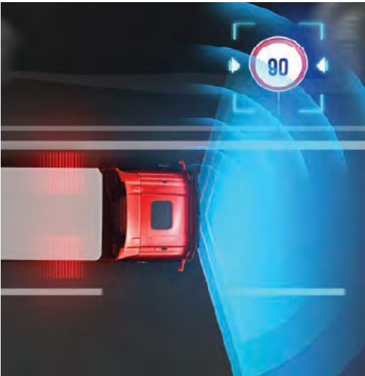
ISA - RECONNAISSANCE DES PANNEAUX DE SIGNALISATION Reconnaît les limitations de vitesse à l'aide de caméras et de données topographiques, avertit le conducteur en cas d'infraction et intervient si nécessaire.
