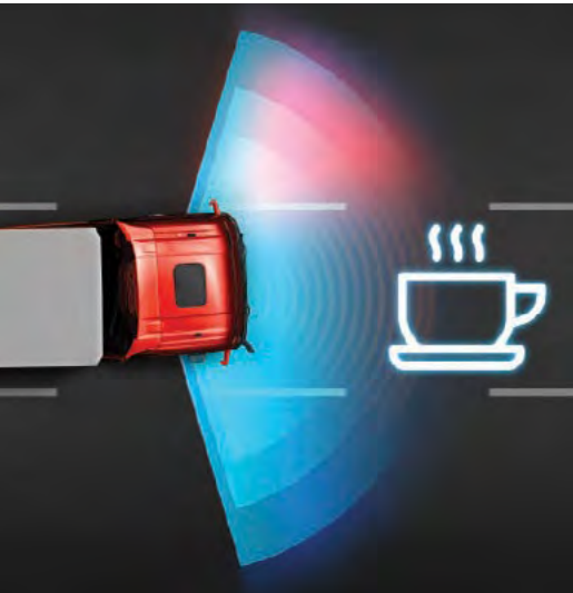
DAWS - DRIVER ALERT SYSTEM Analyseert via camera's het gedrag van de bestuurder om vermoeidheid of afleiding te herkennen, en waarschuwt tijdig om risico's te verminderen.
