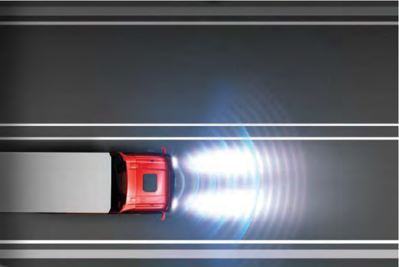
HBA - AUTO HIGH BEAM HEADLAMPS Schakelt automatisch over van grootlicht naar dimlicht wanneer tegemoetkomend verkeer wordt gedetecteerd tijdens het rijden in het donker, waardoor zowel het zicht als de veiligheid worden verbeterd.
