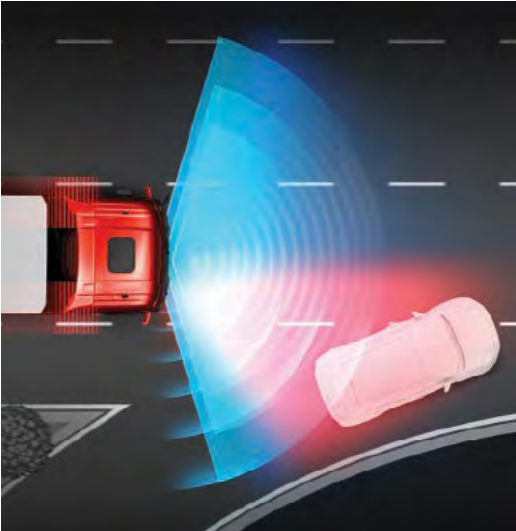
AEBS - ADVANCED EMERGENCY BRAKING SYSTEM Detecteert mogelijke aanrijdingen aan de voorzijde en activeert indien nodig automatisch de remmen.
