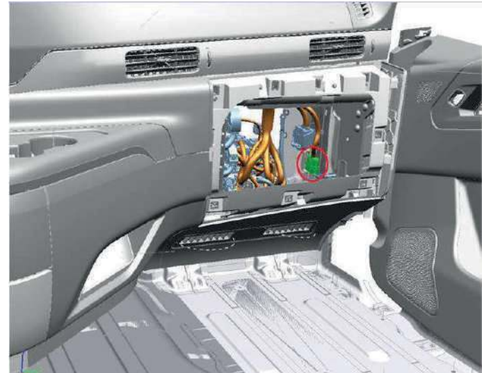
Locația conectorului upfit aflat în camera cutiei de siguranțe
