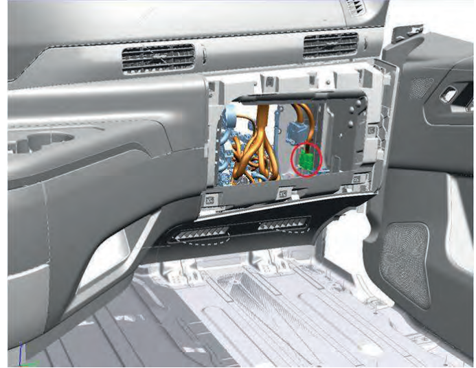
Kabin içinde-torpido gözünde bulunan üstyapı konnektörünün araç üzerindeki lokasyonudur
